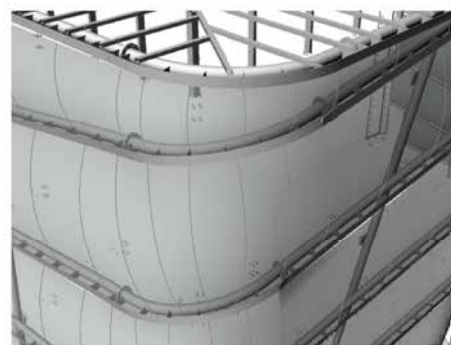
▲ Řešení geometrie rohu – úpon do ALU profilů na sekundární OK
